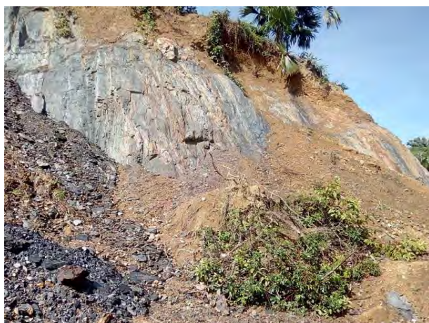
Hình 73: Vật liệu trượt kéo theo đất đá, mảnh vụn và cây cối tại khối 1, TT Vũ Quang, huyện Vũ Quang.
