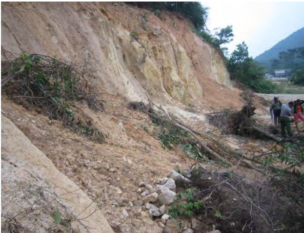
Hình 83: Đới sinh trượt trong khối trượt đá granit phong hóa hoàn toàn
