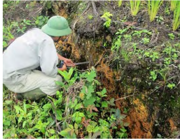
Quang cảnh khối trượt chảy dạng lòng máng. Vết nứt trên đỉnh khối trượt có nguy cơ trượt tiếp. Hình 37. Một số hình ảnh trượt lở tại khối trượt bản Pẻ Ngoài (LC.004264.L4)
