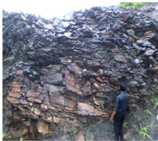
Hình 9. Đá phiến sét đen láng bóng bị nứt nẻ, dập vỡ của hệ tầng Lai Châu, dọc đới đứt gãy Điện Biên - Lai Châu tại khu vực bản Chợ, xã Lê Lợi, Nậm Nhùn.
