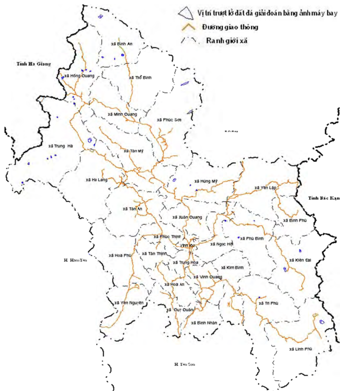
Hình 7: Sơ đồ phân bố các điểm trượt lở đất đá trên địa bàn huyện Chiêm Hóa được điều tra từ giải đoán ảnh máy bay.
